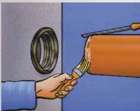
Det tilsluttende røret av-fases og smøres deretter med Forsheda Lub.
