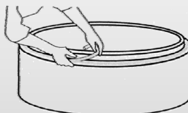
2) Legg på fugebåndet med 5-10 cm overlapp.
